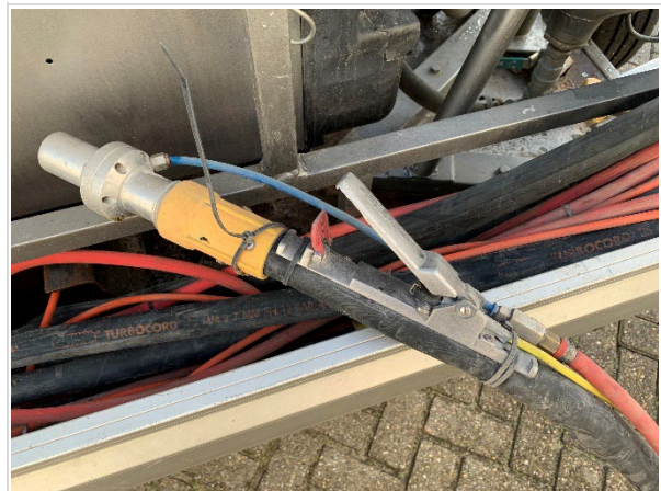
Figuur 9: Spuitmond voor (o.a.) kalkwassen. Via de dunne rood-blauwe slang wordt water aangevoerd, via de dikke zwarte slang lucht met straalmiddel.
