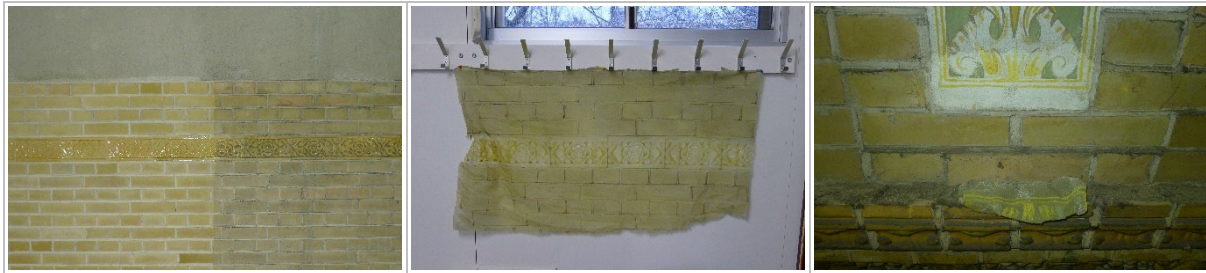
Figuur 11: Reinigingsproven met latex, die mogelijk wat EDTA bevat, in de kathedrale basiliek Sint-Bavo in Haarlem. Links: gereinigde en niet-gereinigde muur; midden: het losgetrokken latexvel inclusief vervuiling; rechts: een proefvlak waarbij de geschilderde verpoederde ondergrond wat kleur heeft verloren (op de latex zichtbaar daaronder).
